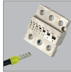
Artikel-Nr. 12515 Für Aderendhülsen 0,14 - 6 mm 2 (Doubleaktion 2 x 0,5 - 2 x 2,5) Crimpbreite: 12 mm
