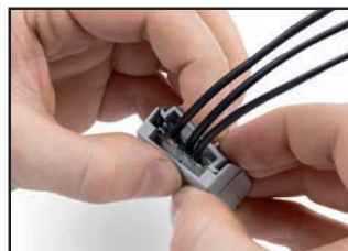
Verrastung sicher verschließen. Close latch securely.
